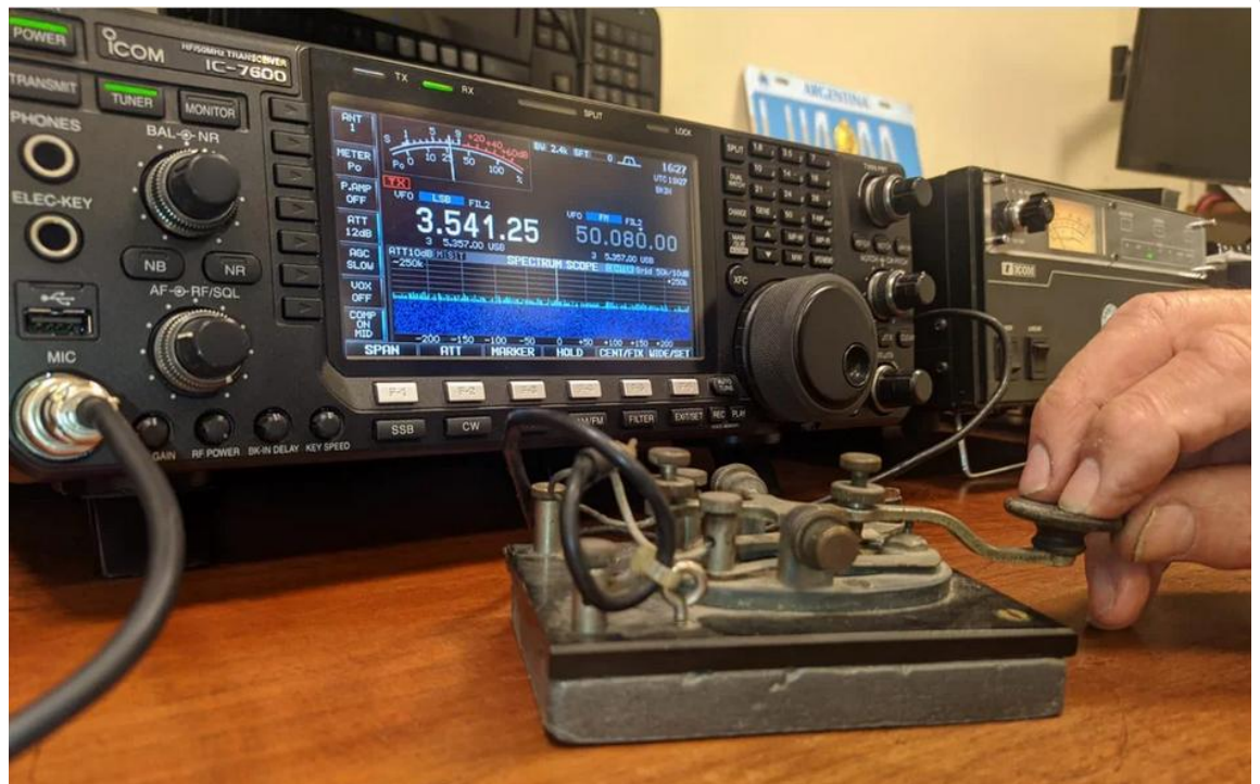
Un manipulador para transmisiones de Telegrafía, conectado a un equipo nuevo con capacidad de conservar los modos más primarios.
