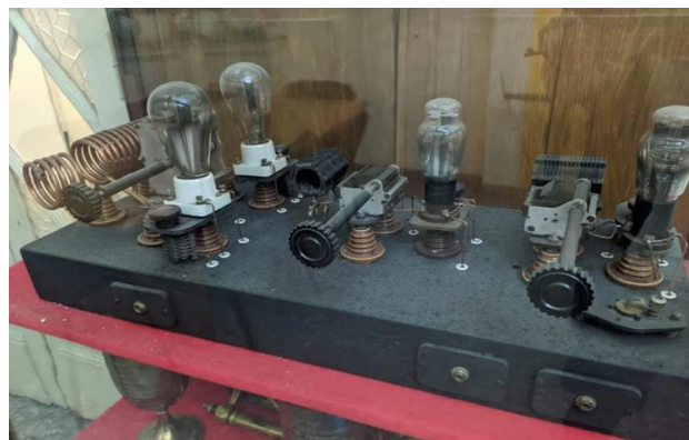
Un transceptor, que transmite y recibe señales... Los antiguos eran muy grandes y con válvulas.
